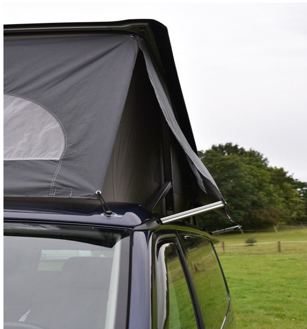
Image 22 - Ventilation latérale- Nouveaux écarteurs. Coins de la toile avant repliés. (Voir doc. Calitop Aufsteller und Wäschetrockner).
