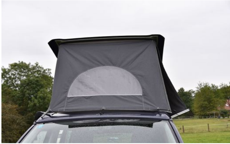
Image 23 - Ouverture du panneau avant et d'un panneau latéral pour ventilation.
