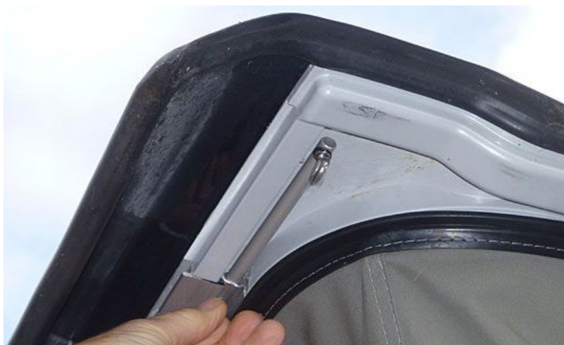
Image 4 - Pose d'un support long à l'avant du toit. Vue du coin avant droit du toit.
