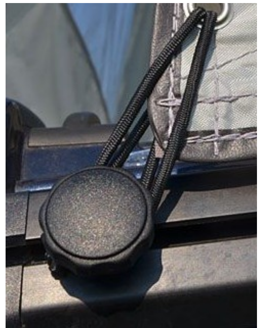
Images 26 et 26 bis - Raccourcissement d'une boucle-Pose en double boucle.
