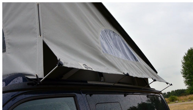
Image 21 - Ventilation latérale- Anciens écarteurs.
