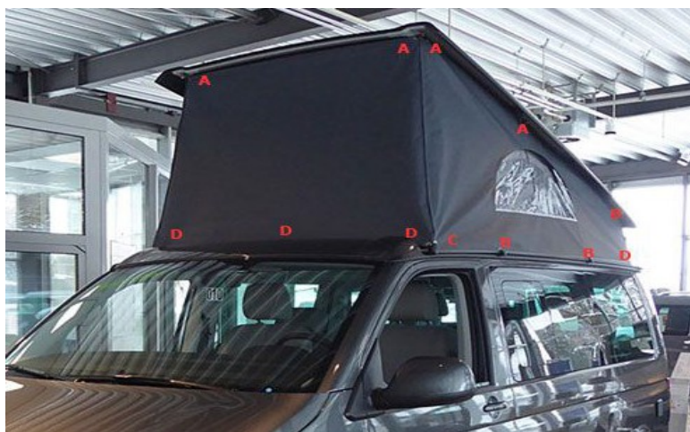
Image 2 - Calitop monté à l'extérieur des ciseaux sur toit manuel.
