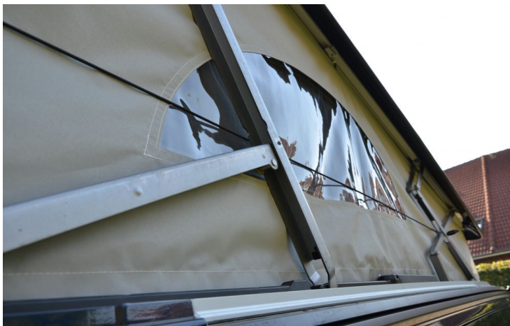
Image 13 - Mise en tension de l'élastique périphérique.
