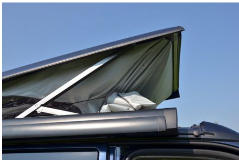
Image16 - Descente du toit. Effet de rétraction de l'élastique périmétrique.
